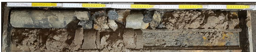
Obr. č. 1 - Diagnostický vrt V1
